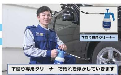
下回り専用クリーナーで汚れを浮かしていきます
