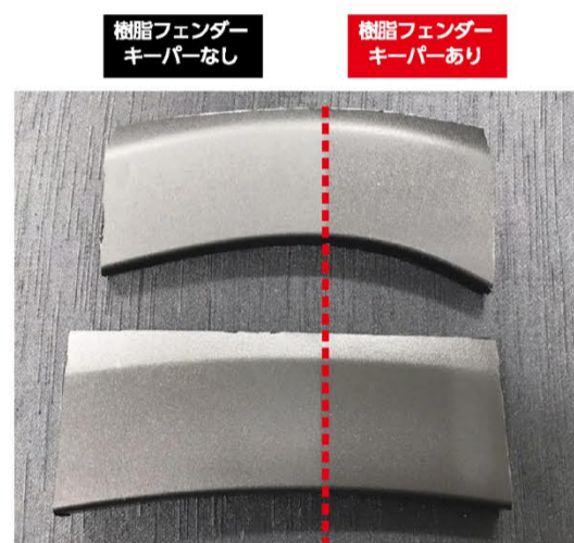
1年の促進耐候試験(紫外線照射)をした樹脂フェンダー比較 ※実際の軽自動車のカット部品を使用
