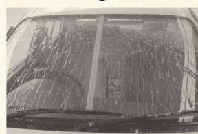
両方ともスポンジでこすってから、全体に水をかけてみる。インセクトリムーバーの方は撥水コートに異常なし
