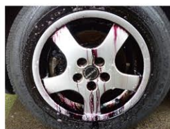
BDCと錆が反応し、赤くなっている
