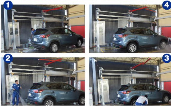
足回りのスプレーが終わったら、水→泡コースのスイッチを入れます。
