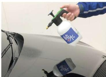
※ダイヤモンドキーパー(または、Wダイヤモンドキーパー)の施工、ガラス被膜の硬化時間を短縮する方法。ダイヤモンドキーパーのガラス被膜に「純水」を噴きかけることで、ガラス被膜表面を強制的に硬化促進させる方法です。水ジメをすると、すぐにレジン被膜が塗布できる状態になります。
