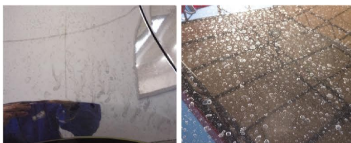
消雪パイプや融雪剤による側面の汚れ 鉄鋼所付近に駐車している車の石灰汚れ
