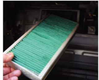
エバボレーターの洗浄方法は、まずエアコンフィルターを外し、そこから専用の洗浄剤を注入します。数分後、エアコンのスイッチを操作し、洗浄剤で分解され溶け出た汚れ(カビなど)を車外へ洗い流すというもの。
