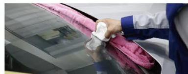
細部は、人の手と「魔法の道具」で丁寧に、ウロコを除去します。
