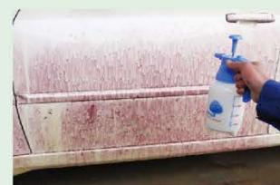
⇒表面の鉄錆は比較的簡単に落ちます。
