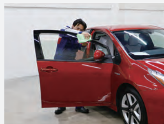
窓ガラスの上端 窓ガラスを少し下げ窓ガラスの上端 とバイザーの裏をきちんと拭く
