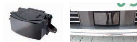
(写真) フロントナンバー下のLiDAR
