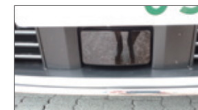
(写真) フロントナンバー下のLiDAR
