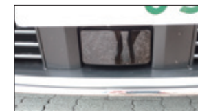
(写真) フロントナンバー下のLiDAR
