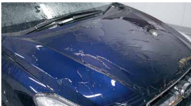
撥水阻害被膜により部分的に水はじきが低下することがあります。
