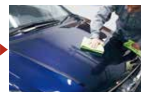
洗車の拭き上げをしながら撥水阻害被膜を掻き取る
